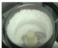
ドライアイス粉碎 ペレットまたはブロック状のものをパウダー状に粉碎
