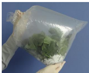
試料の予冷（試料とパウダー状ドライアイスを混合）
