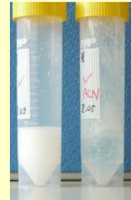
左) アセトン 右) アセトニトリル 抽出溶媒を加えて振とうした牛脂
