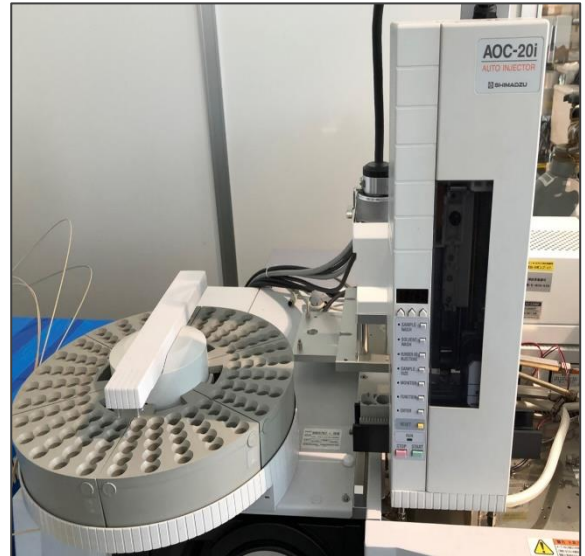
AOC オートサンプラ設置状態(フロント注入口)
