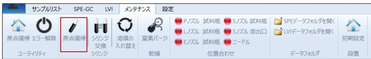
取り外したシリンジと容量の異なるシリンジを新たに取り付けた場合、ソフトウェアの「装置構成」を変更する必要があります。リボンメニューの「サンプルリスト」にあるウィンドウ表示項目の「装置構成」にチェックを入れます。ウィンドウ表示に「装置構成」画面が表示されるので、交換したシリンジ番号の容量をプルダウンメニューから選択します。
