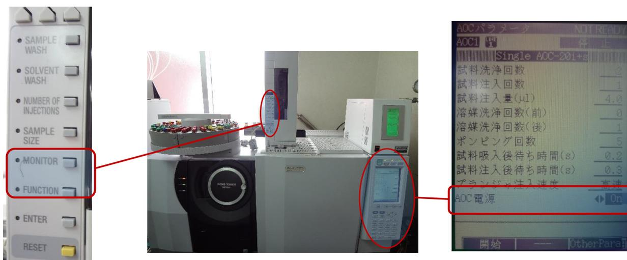
※ 電源が入った後、オートインジェクタの MONITOR および FUNCTION のランプが点灯していることを確認してください。
