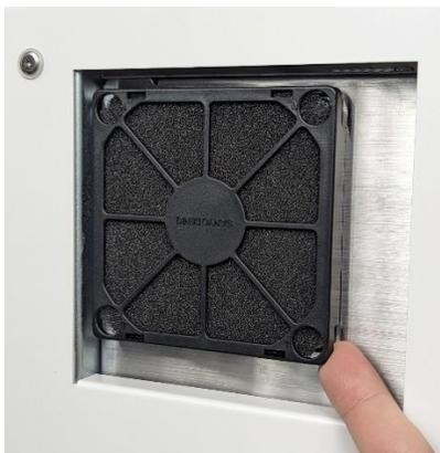
3. 古いフィルターを取り外し、新しいフィルターを取り付けます。
