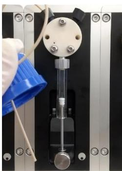
ソフトウェア (SGI-STUDIO) のリボソメニューにある「メンテナンス」から「溶媒の入れ替え」を実行し、エアーを引き込んでライン中の溶媒を押し出します。
