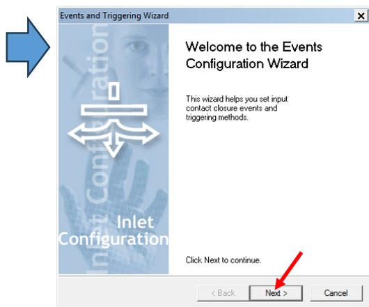
イベント設定画面で「Event In」の1にチェックを入れ、トリガーマソッド設定の Pump 項目で「Trigger by Software」にチェックを入れます。
