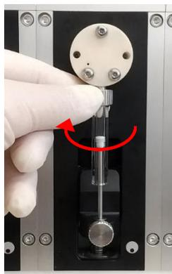
シリンジを一番下まで指で押し下げ、プランジャーを固定している下側のネジを矢印の方向に回して緩め、シリンジを取り外します。
