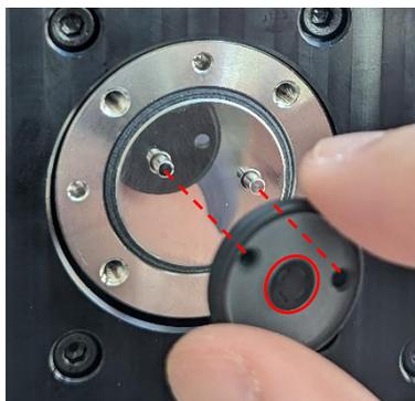
ローターシールの取り付けが完了したら、バルブ台座の穴とスペーサーの突起が合うようにスペーサーを取り付けます。このとき、切り欠きが手前下にくるように取り付けます。
