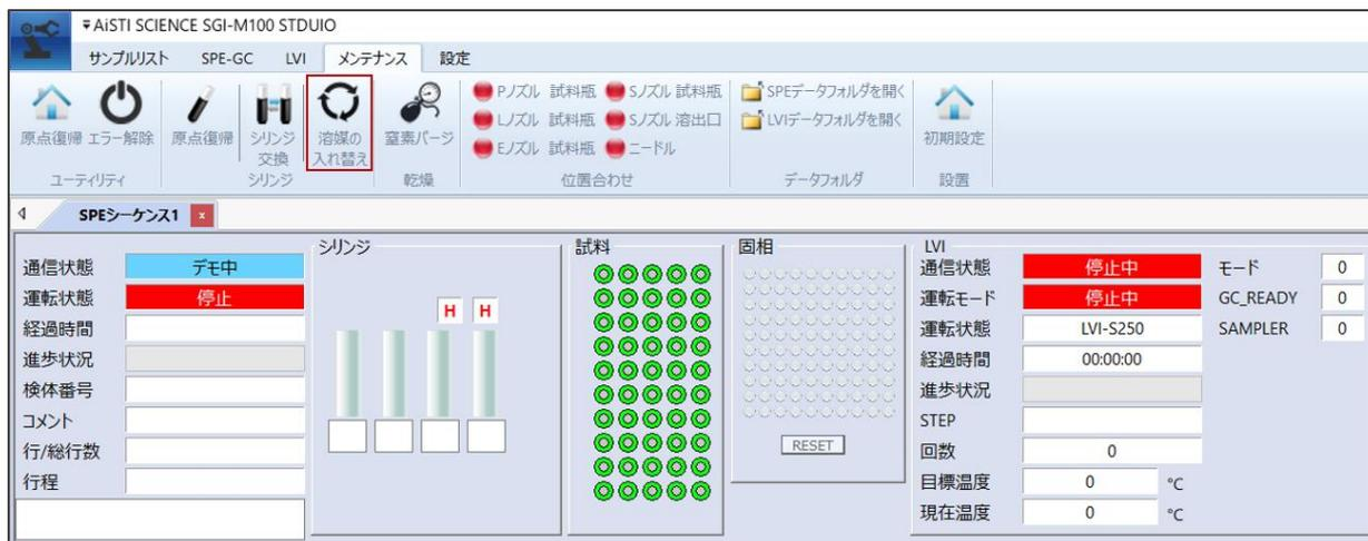
リボンメニューの「メンテナンス」から「シリンジ交換」のアイコンをクリックします。
