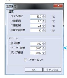
注入回数のデフォルトは 500 です。 ヒーター時間のデフォルトは 1000 です。 ポンプ時間のデフォルトは 1000 です。 アラーム設定のデフォルトは OFF です。
