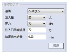
推奨表示は注入法が、コールドオンカラム・大量注入・大量注入(プレカラム)・その他が選択されていた場合、溶媒はヘキサン・アセトンジクロロメタン・トルエン・アセトン/ヘキサン
