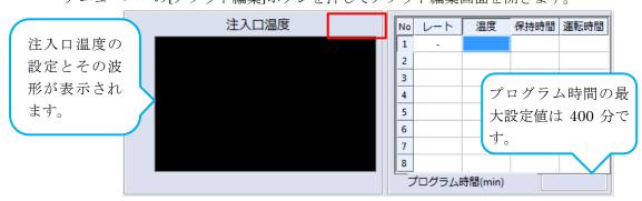
レート・温度・保持時間によって注入口温度の温度勾配が表示されます。
