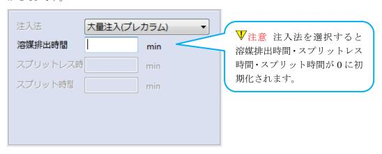
溶媒排出弁 1 がある場合、注入法はスプリット・スプリットレス・コールドスプリット・コールドオンカラム・大量注入・大量注入(プレカラム)・その他、の中から選択します。
