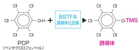
試料にはペンタクロロフェノール(PCP)、誘導体化試薬には1%濃度のBSTFAを用いて誘導体化注入法の評価を行いました。このSCANクロマトグラムとスペクトルからインサート内で確実に誘導体化が行われていることがわかりました。
