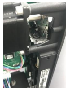
図3 液漏れにより装置内部に塩の析出したシリンジポンプ
