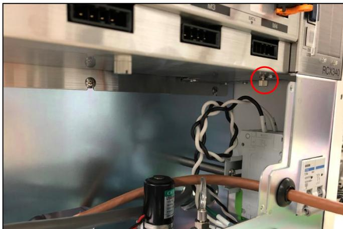
カバーごとバッテリーを引き出し、配線の根本部分を持って下に引っ張ってコネクタを外します。新品のバッテリーに交換後、コネクタを挿入してカバーを閉めます。
