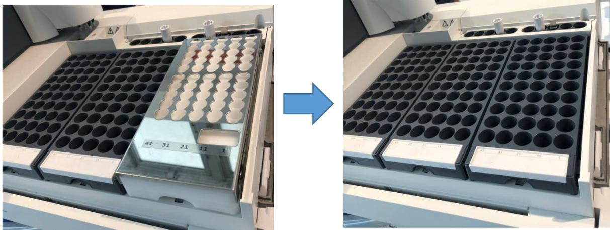
固相廃棄ボックス手前に引き抜き、取り外します。
