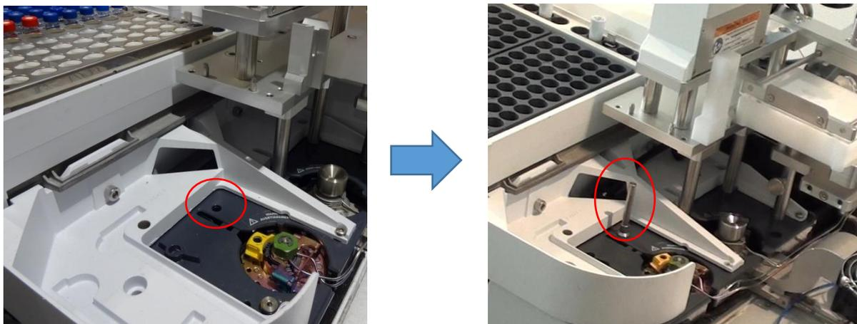
フロント注入口にインジェクターをセットします。
