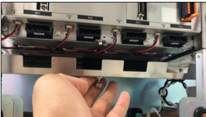
バッテリーから伸びているコネクタを抜き、バッテリーを取り外します。装着されている4本のバッテリー全てを外し、新品のバッテリーと交換します。バッテリーのコネクタを全て挿入し、カバーを取り付けます。
