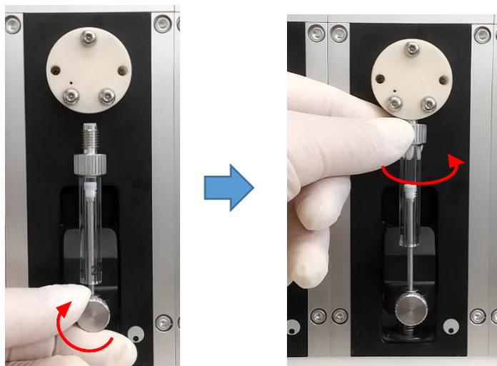
シリンジの取り付けが終わったら、ソフトウェアからシリンジの原点復帰を行います。リボンメニューの「メンテナンス」からシリンジの「原点復帰」アイコンをクリックします。プランジャーが一番上の位置まで戻り、交換終了となります。
