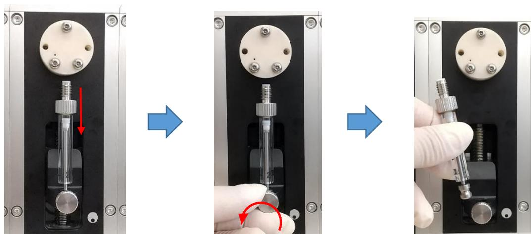
交換する新しいシリンジを準備します。取り外した手順と逆の手順でシリンジを取り付けます。下側と上側のネジを矢印の方向に手で回して固定します。
