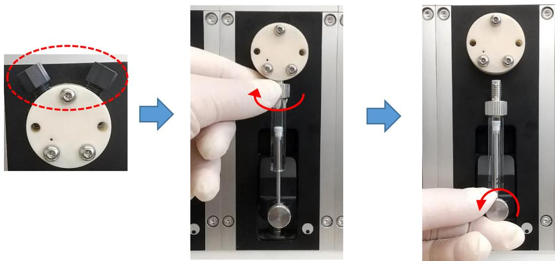
セラミックバルブの場合は、固定している六角ナットを 2 mm 六角レンチで外します。
