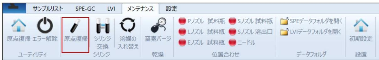
取り外したシリンジと容量の異なるシリンジを新たに取り付けた場合、ソフトウェアの「装置構成」を変更する必要があります。リボンメニューの「サンプルリスト」にあるウィンドウ表示項目の「装置構成」にチェックを入れます。ウィンドウ表示に「装置構成」画面が表示されるので、交換したシリンジ番号の容量をプルダウンメニューから選択します。
