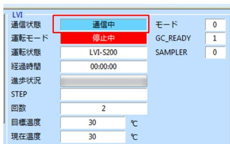
通信状態が「停止中」で、ウィンドウが赤色の表示になっている場合は通信ができていません。通信ができない場合、パソコンのCOMポート設定が正しく行われているかを確認してください。設定タブの通信ポートにある「SPE-GC」および「LVI-S250」アイコンをクリックし、「USB Serial Port」と表示された通信ポートの中から正しいポート番号に設定を行ってください。
