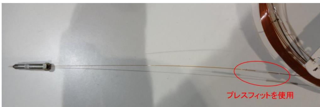
注入口への挿し込むカラム長さはフェラルの先端から 10 mm に調整してください。カラムにナットとフェラルを付けてから注入口に一度固定し、取り外します。カラムがわずかにフェラルで締め付けられた状態で作業をして頂くと、長さ調整がし易くなります。フェラル先端からの長さを調整した後に、注入口へカラムナットを取り付けてください。
