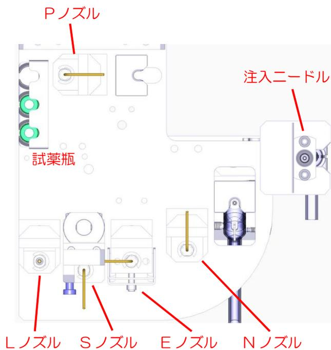
左図赤文字(ノズル/アダプタ/試薬瓶/カートリッジ) を全て取り外したところ。
