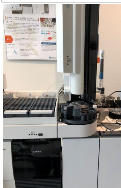
オートインジェクター設置状態(フロント注入口)
