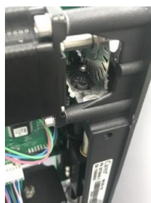
図3 液漏れにより装置内部に塩の析出したシリンジポンプ
