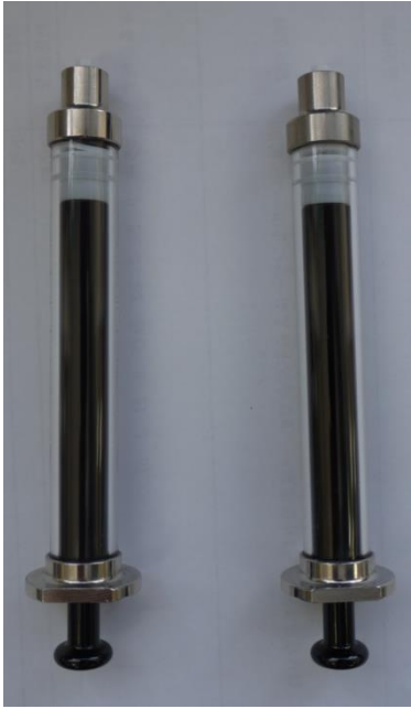
シリンジの差異 (左 : 消耗 右 : 正常)
