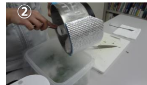
② 試料にドライアイスを加える。
