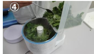
④ 予めドライアイスを入れておいたフードプロセッサーに試料を入れる。
