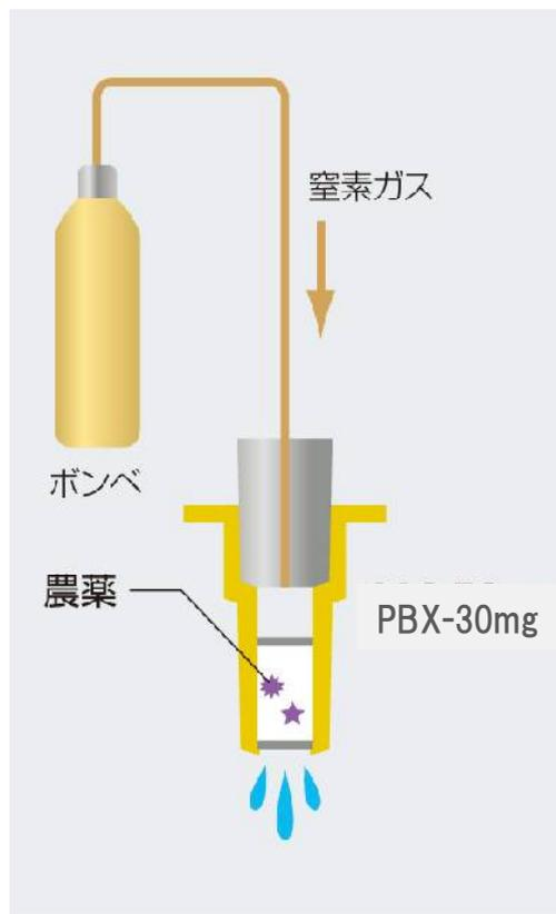
窒素ガスでラインと固相3% ;の水分を除去・乾燥
