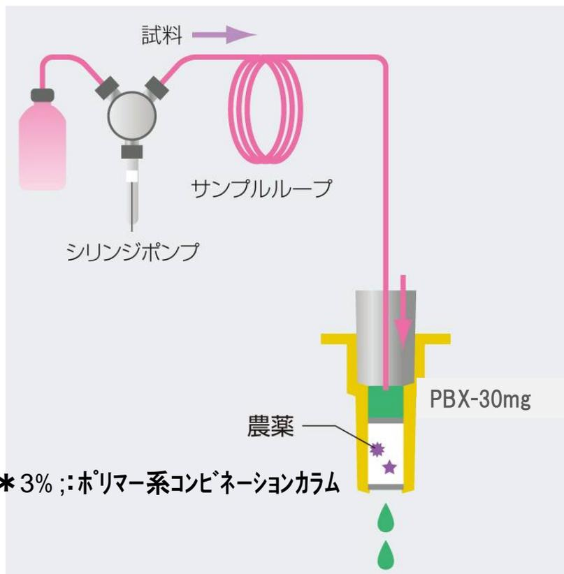
試料水を固相3% ;に通水し、農薬を固相に保持させる
