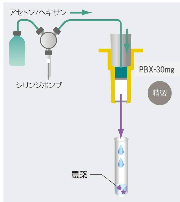
アセトン ヘキサン( ) P/で固相3% ;から農薬を溶出させる。
