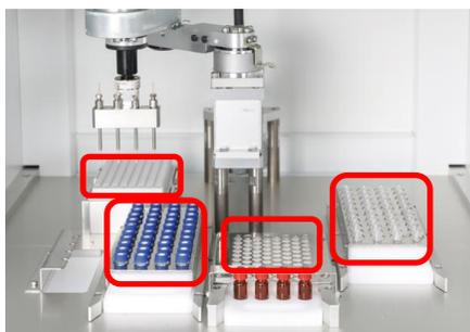
②固相、チップ、バイアル瓶(試料・溶出)をセット
