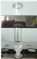
PBXの下にPSAを連結させ、アセトンへヘキサン(15/85) 1 mLで溶出
