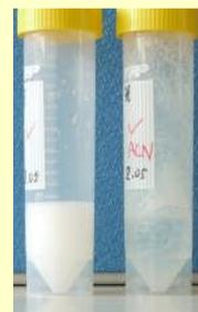
左) アセトン 右) アセトニトリル 抽出溶媒を加えて振とうした牛脂
