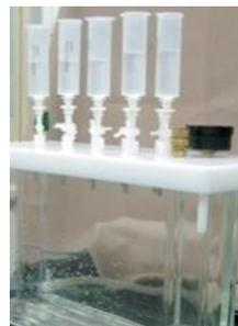
抽出液を特殊なフィルター（固相カートリッジ）を通過させ、色素や脂質など農薬以外の成分を除去し農薬だけを回収する。
