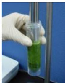
農薬が溶けやすい液体に抽出（主に有機溶媒を使用）
