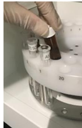
⑨試料液とメス試験官を装置にセット
