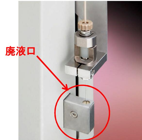
固相カートリッジが再び廃液口に連結され、溶出溶媒で配管および固相を洗浄します。
