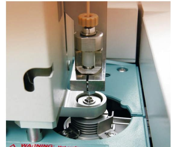
ニードルのついた固相カートリッジが自動的にGC注入口へ連結され、目的物質を固相から溶出しながら、GCへ直接注入します。
