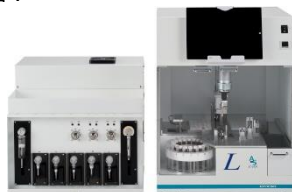
全自動固相抽出装置 ST-L400 (アイスティサイエンス)
