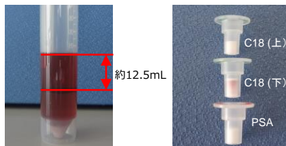
遠心分離後のACN層① (約12.5mL) 精製後の固相 (C18(上), C18(下), PSA)
